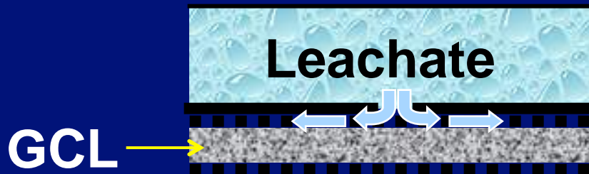
Composite Liner (GM + GCL)
